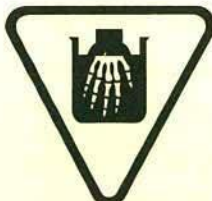
Riesgo de corrosión.
