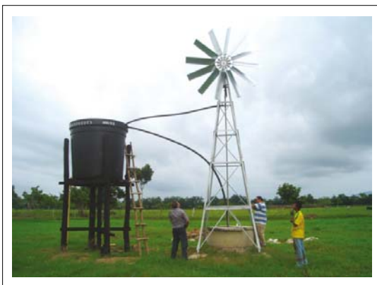
Molino de viento con tanque reservorio para bebedero de ganado, instalado por Molinos El Oasis de Barranquilla en finca del Doctor Roberto Tatis, Bolívar.
