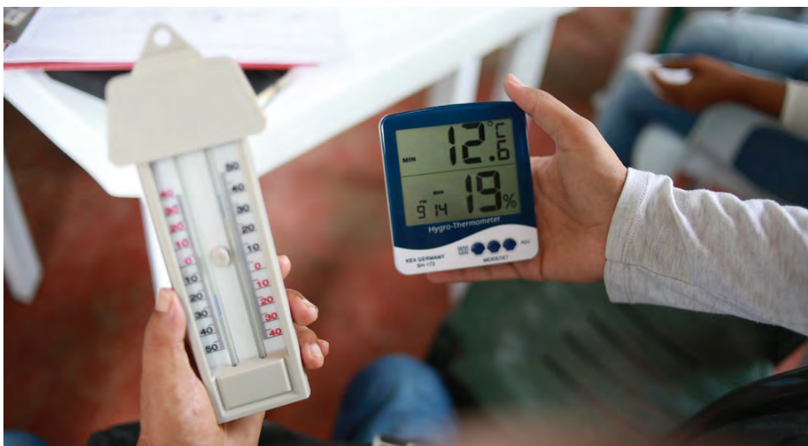
Figura 27. Lectura de las condiciones de temperatura y humedad relativa de un BLS. A la izquierda se observa un termómetro de máximas y mínimas, mientras que a la derecha se detalla un termohigrómetro que mide temperatura y humedad relativa.
