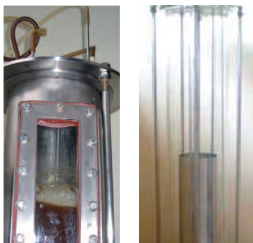
Figura 2. Fermentador airlift utilizado para la producción del preinóculo de T. koningiopsis Th003
