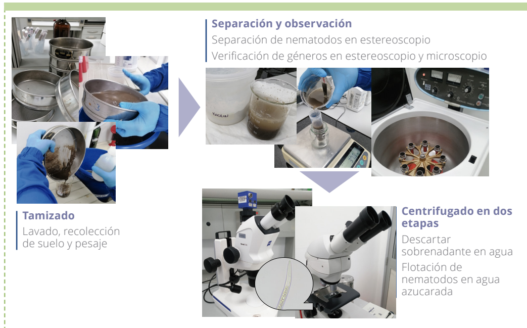
▲ Figura 6. Método de extracción de nematodo edáficos asociado a M. maximus en el modelo productivo de ganadería sostenible del Caribe colombiano.
