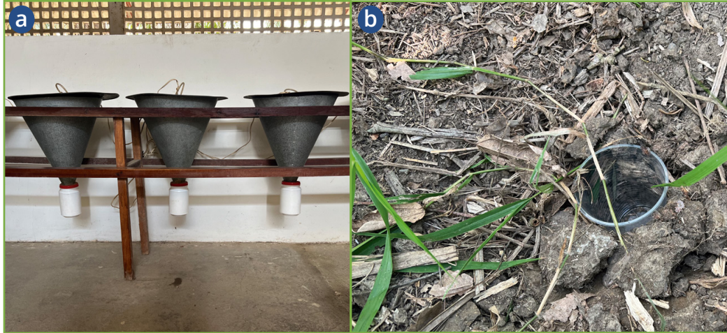
▲ Figura 8. Métodos para el muestreo de artrópodos. a. Embudos Berlese-Tullgren; b. Trampas de caída o pitfall .
