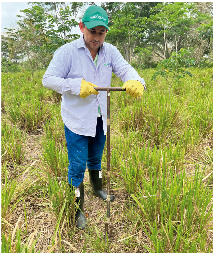
▲ Figura 11. Toma de muestra de suelo con barreno en el modelo productivo de ganadería.
