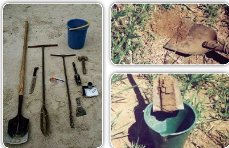
Figura 6.2. Toma de muestras de suelo
