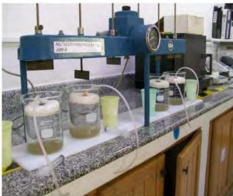
Foto 1. Montaje de un ensayo de trazabilidad (test de jarras)
