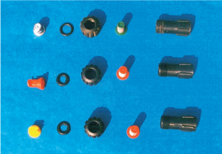
Figura 4. Componentes integrales de un sistema de boquillas cono, cortina y abanico.
