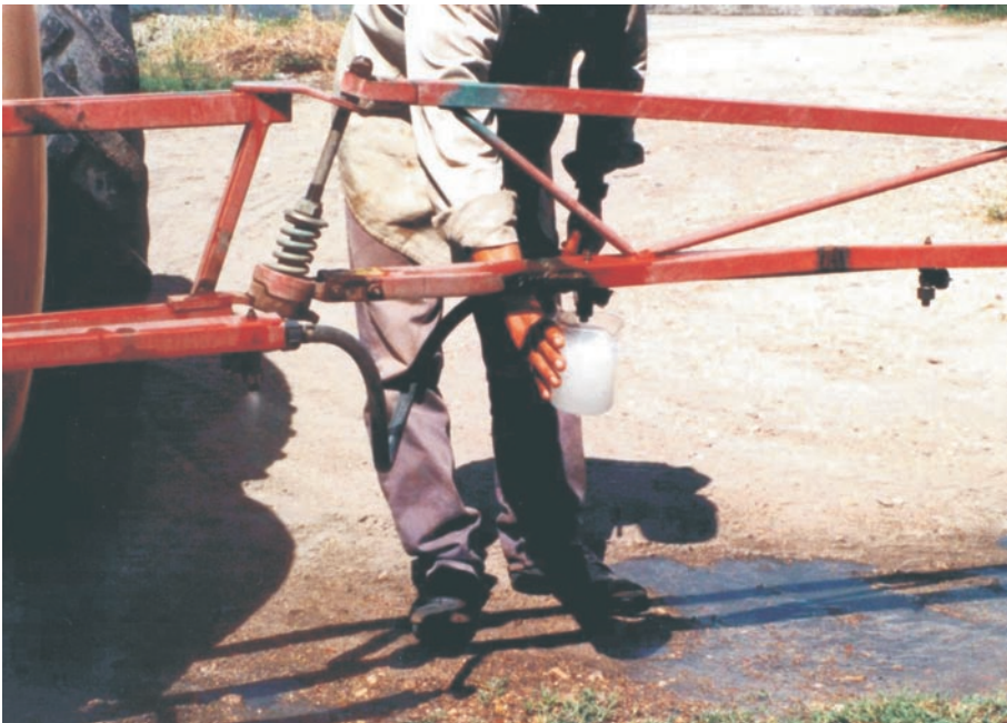
Figura 5. Medición del flujo de descarga de las boquillas.
