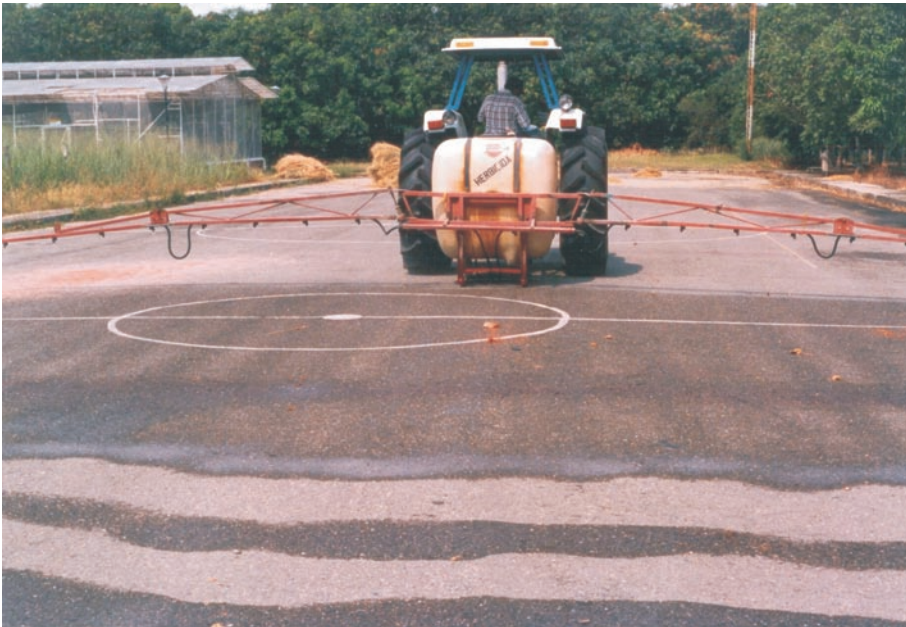
Figura 8. Posición horizontal adecuada del aguilón a la altura de 50 cm, para aplicación uniforme en el campo.
