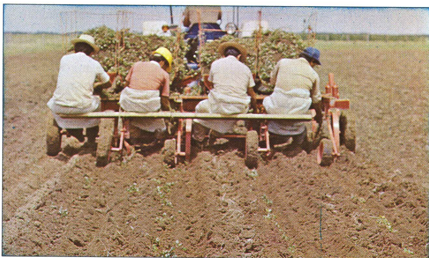
Figura 5. Siembra de A. pintoi con material vegetativo, utilizando la maquinaria diseñada para este fin.
