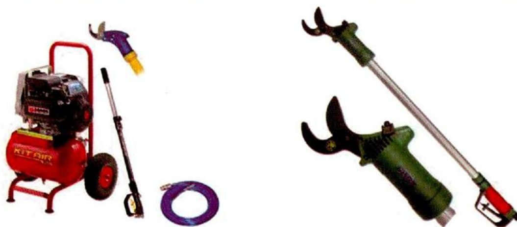
Elementos podadora neumática de tiro (Motor-compresor, Manguera, tijera y mango telescópico para tijera)
