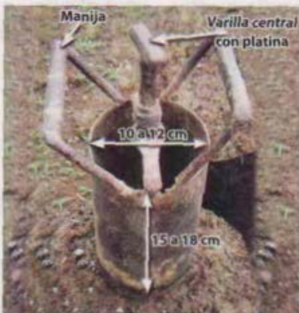
Figura 52. Ahoyador metálico para trasplante de plántulas
