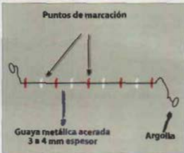
Figura 37. Cinta graduada para marcación de sitios de colocación de bolsas de vivero
