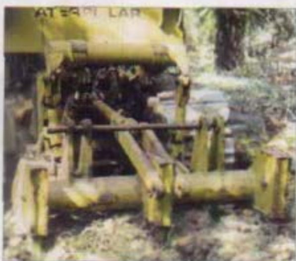
Figura 22. Subsólador de tres cuerpos acoplado a un bulldozer
