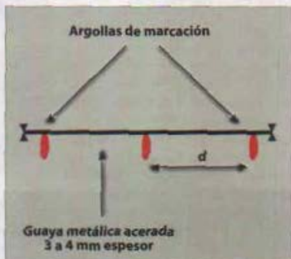
Figura 38. Cuerda de trazado para marcación de puntos de siembra en sitio definitivo
