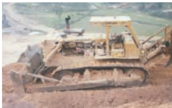
Foto. Bulldozer con ripper para efectuar preparación de frentes de explotación. (Cortesía David Buitrago Salomón)
