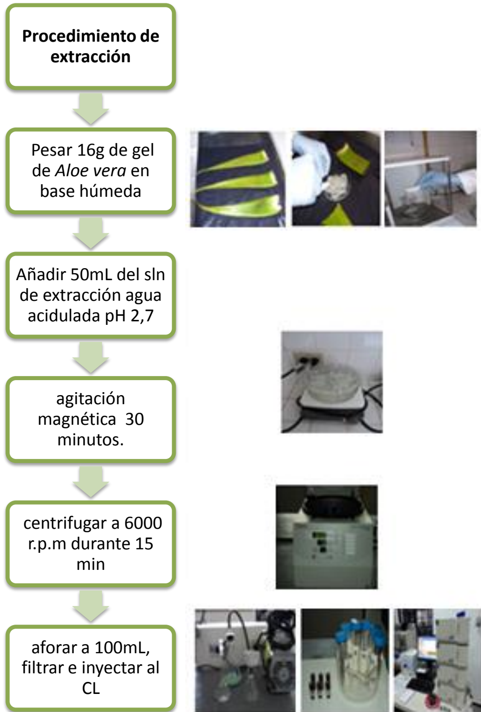
Figura 28. Extracción de ácido ascórbico del mucílago de Aloe vera . Fuente: Del Autor.
