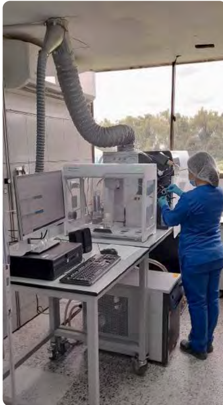
Figura 4.9. Paso 4. Cuantificación de Cd en las muestras por ICP-MS.
