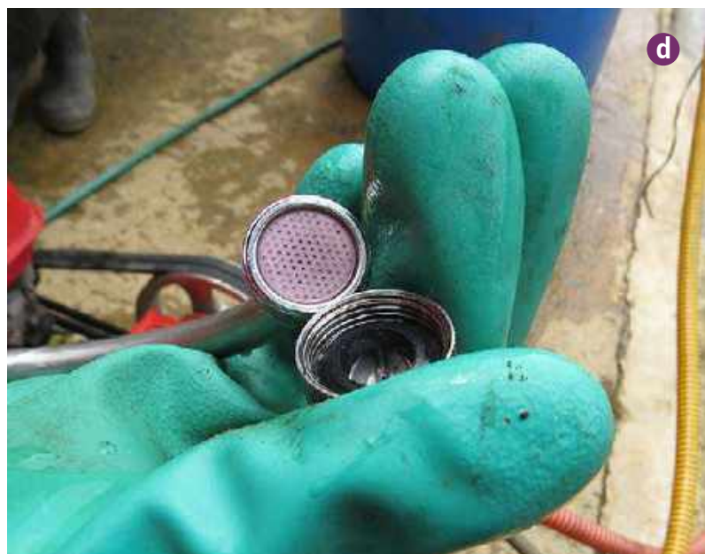
Figura 140. Revisión de filtros. a. Filtro del tanque; b. Filtro de la llave; c. Filtro del portaboquillas; d. Filtro de una boquilla de máquina a motor.
