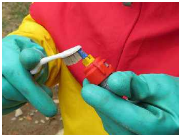
Figura 141. Limpieza correcta de la boquilla.
