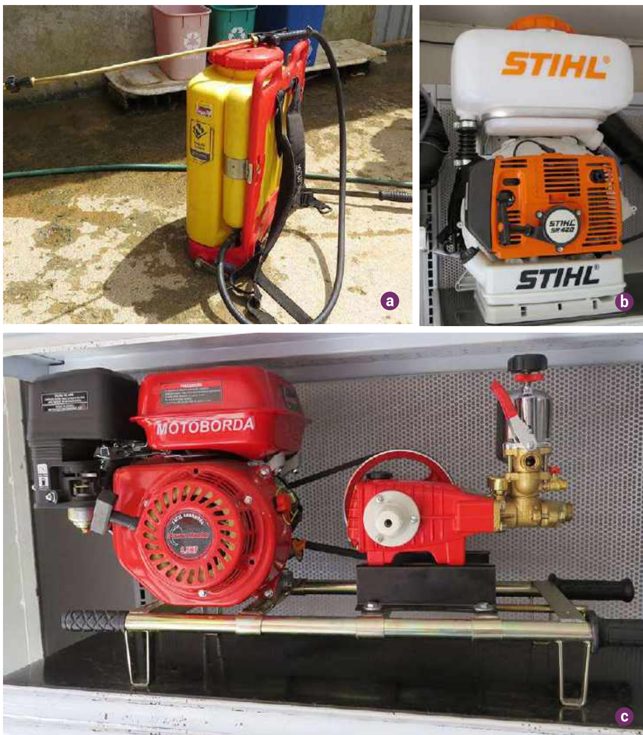
Figura 136. Equipos de fumigación. a. De palanca; b. Motorizado de espalda; c. Semiestacionario.
