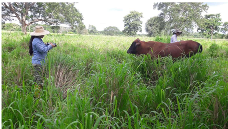
Figura 28. Cuantificación de metano entérico con sensor láser en animales F1 (Romosinuano x Cebú) en el CI Turipaná.
