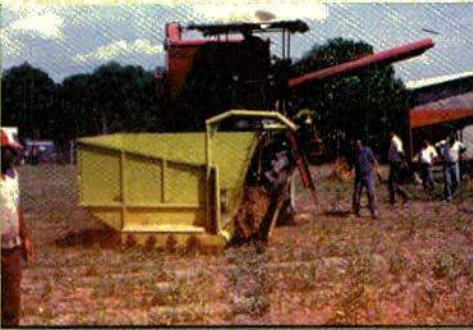
Foto 16. Trilladora de ajonjolí con alimentación de los urones en forma mecánica (pescozón)
