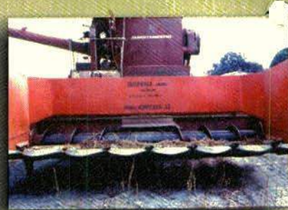
Foto 16. Trilladora de ajonjolí con alimentación de los urones en forma mecánica (pescozón)
