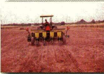
Foto 13 y 14. Sembradora Max Emerge de siembra directa y de precisión; el sistema de vacío por medio de un vacum permite la siembra de precisión.
