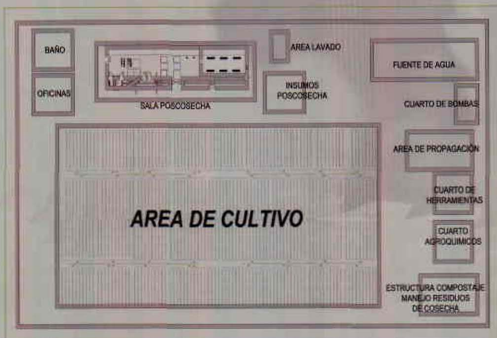
Figura 41 Esquema de infraestructura general propuesto para el cultivo de menta
