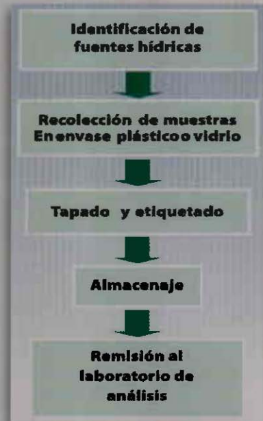
Figura 19 Diagrama de flujo para la toma de muestras de agua para análisis químico
