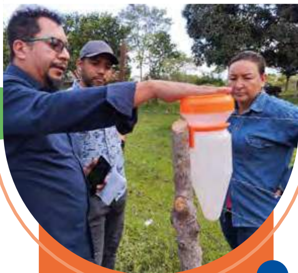
Estación climática - instalación de pluviometro Orinoquía
