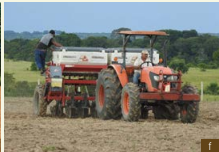
Figura 5. Tipos de sembradoras. a. Sembradora de un surco mecánica; b. Sembradora de dos surcos mecánica; c. Sembradora siembra directa de precisión mecánica; d. Sembradora de dos surcos neumática; e. Sembradora de 4 surcos neumática; f. Sembradora de precisión para siembra directa.
