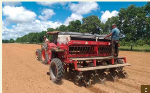
Figura 5. Tipos de sembradoras. a. Sembradora de un surco mecánica; b. Sembradora de dos surcos mecánica; c. Sembradora siembra directa de precisión mecánica; d. Sembradora de dos surcos neumática; e. Sembradora de 4 surcos neumática; f. Sembradora de precisión para siembra directa.
