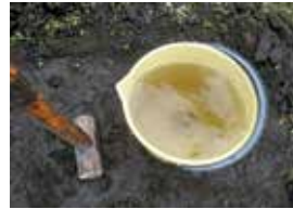
Agua en movimiento: suelo poco compactado
