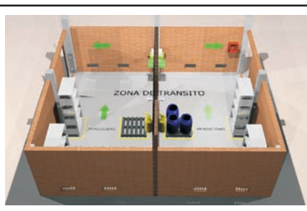
Figura No. 6. Adecuada ubicación, apilamiento e identificación de las zonas en una bodega.
