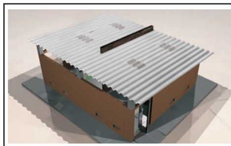
Figura No. 5. Muro cortafuego e iluminación con láminas traslúcidas.
