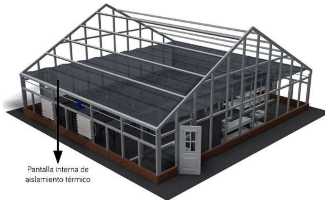
Figura 44. Pantalla interna de aislamiento térmico.
