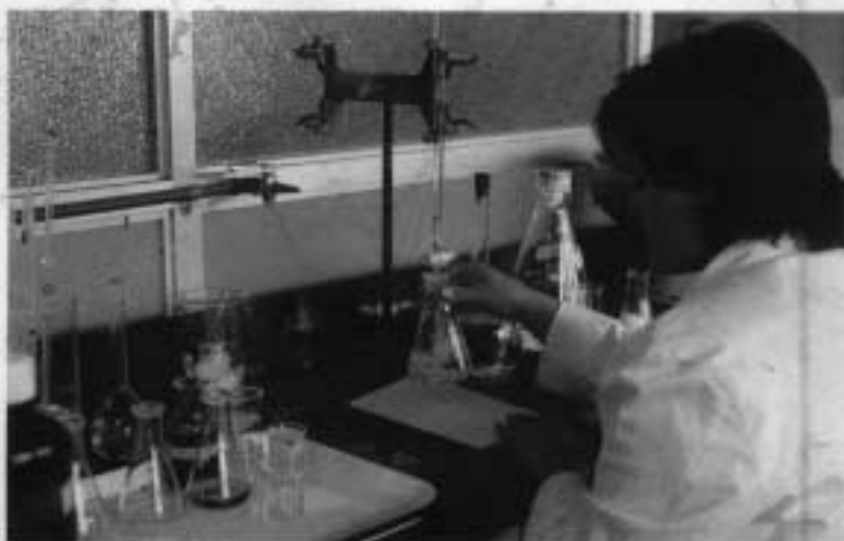
Figura 2. Equipo utilizado para el análisis del contenido de azúcar en el algodón por el método del Ferrocianuro de Potasio.
