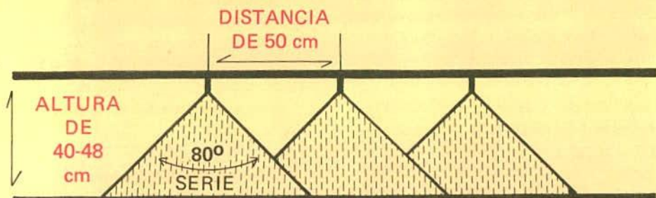
Figura 1. Altura del aguilón con boquillas de abanico plano (Tee-jet)
