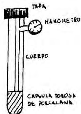
Figura 1. Partes principales de un tensiómetro.
