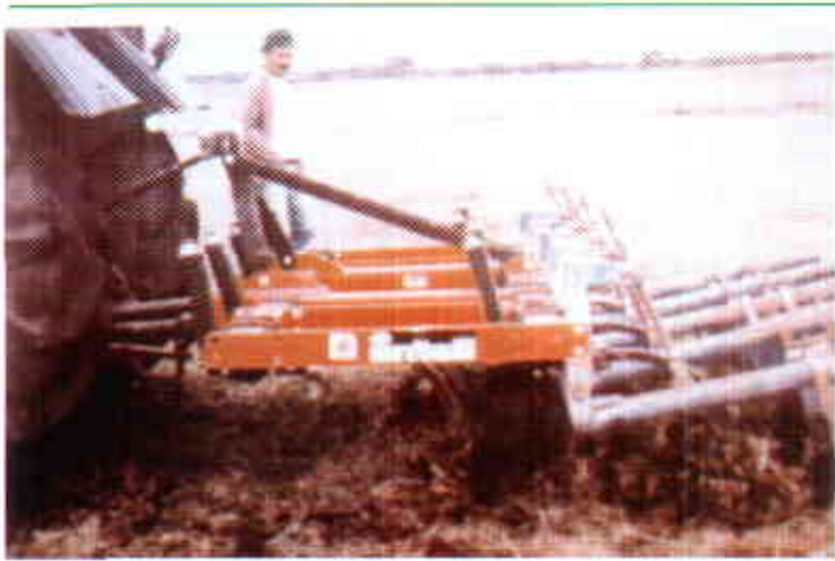
Figura 3. Cincel flexible adaptado con implemento desterronador en la parte posterior. Corpoica, 1998.
