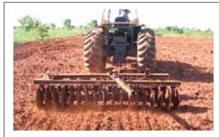
Operación de la rastra niveladora cerrada
