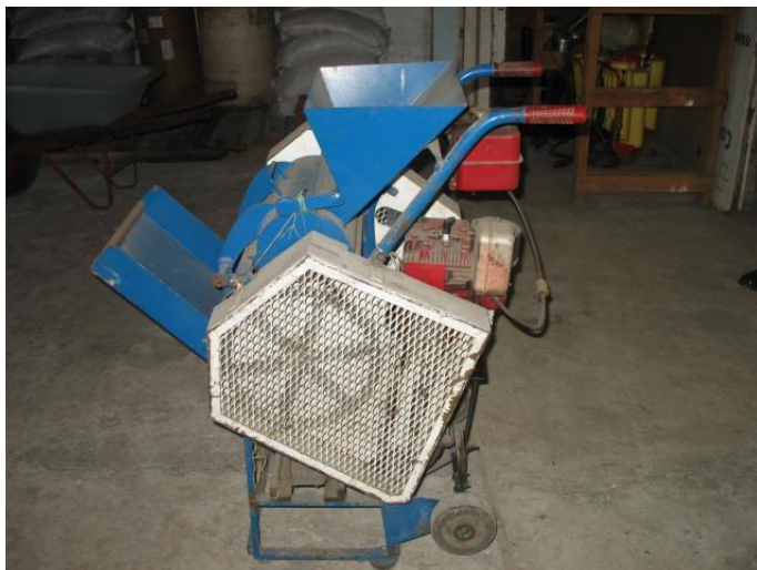
Figura 28. Desgranadora de fríjol de pequeño tamaño Fuente: Corpoica (2013).
