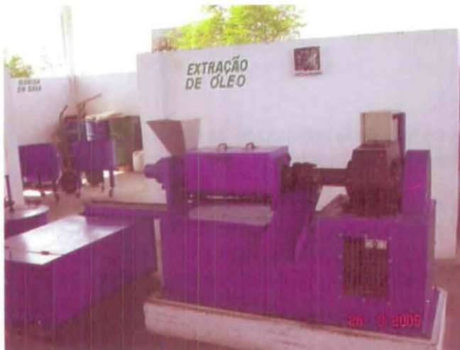
Figura 3. Prensa para la extracción de aceite de higuera en mini-plantas.
