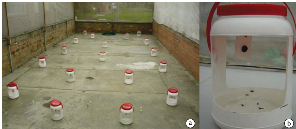
Figura 19. Esquema del montaje de casa de malla. a. Disposición de trampas en la casa de malla; b. detalle de una trampa de caída. Fotografía: Laboratorio de Control Biológico, Corpoica.
