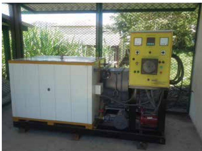
Figura 17. Cámara de tratamiento térmico para eliminar las enfermedades como la escaldadura de la soca y el raquitismo de la hoja.
