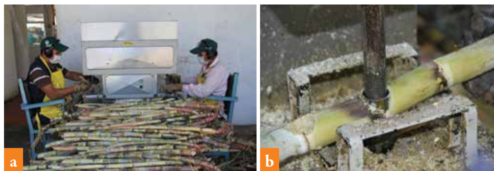
Figura 14. a. Máquina extractora de yemas; b. Extracción de yemas de caña de azúcar.
