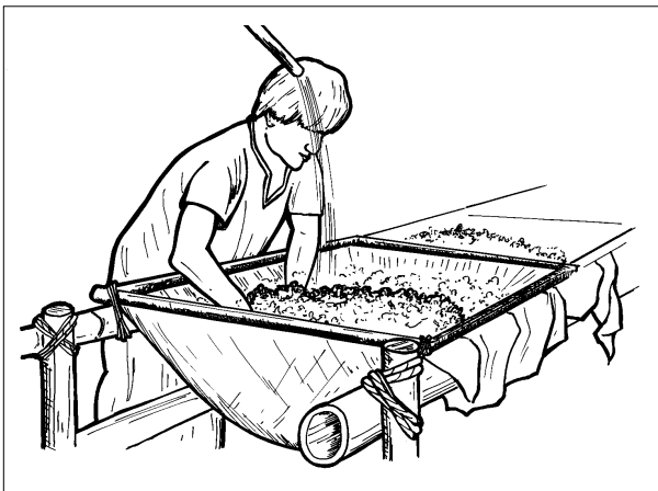
Figura 12. Colado manual de la masa de yuca rallada, tal como se practica en el departamento del Cauca.
