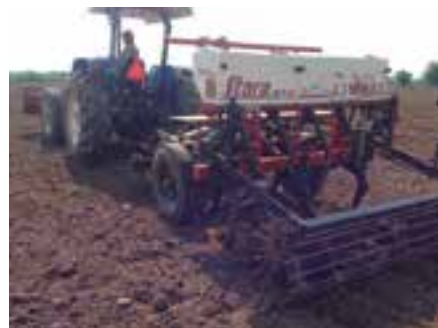
Figura 16. Implemento renovador - sembrador
