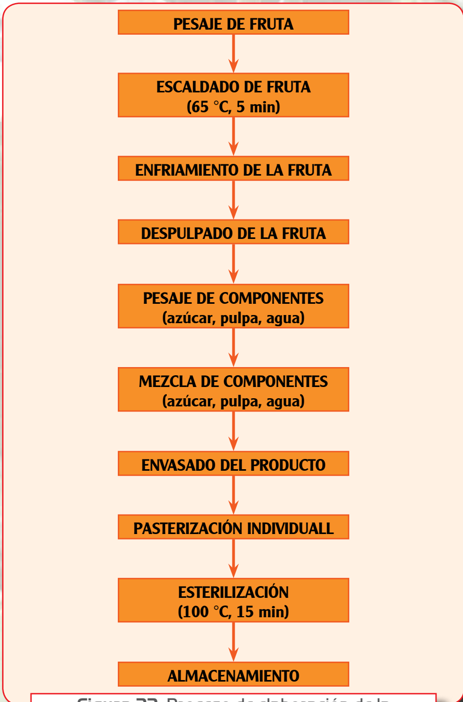
Figura 33. Proceso de elaboración de la aromática de tomate de árbol (Campos A., 2006).
