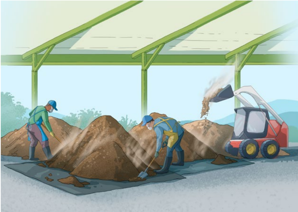
Figura 17. Volteo de la pila manual y con Bobcat para controlar la temperatura y la humedad.
